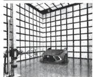
大帯域や強さを測定できる設備を美和技術センター(愛知県あま市)にこのほど導入した。自動車運転技術が進展するなか、最新型の電波暗室を導入(イメージ)
